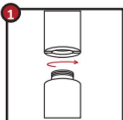
Schrauben Sie den Verdampfer im Uhrzeigersinn auf den Lea-Akku. Achten Sie bitte darauf, dass sich die Gewinde nicht verkanten, da sie dadurch beschädigt werden können.
