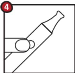
**Drücken und halten Sie den Auslöseknopf des Akkus und ziehen Sie gleichzeitig am Mundstück. Das Gerät ist nur so lange aktiv und produziert Dampf, wie Sie den Knopf gedrückt halten.**
