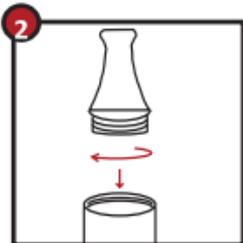
Befüllen des Verdampfertanks: Schwarzes Mundstück gegen Uhrzeigersinn abschrauben. Verdampfer leicht schräg halten und Liquid in den Verdampfertank bis zur oberen Skala einfüllen. Mundstück wieder auf den Verdampfer setzen und im Uhrzeigersinn festschrauben.
