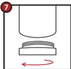
**7** Akku laden über USB: Entfernen Sie die silberne Kappe an der Unterseite des Akkus. Verbinden Sie das Gerät über das mitgelieferte USB-Kabel direkt mit einem PC oder verwenden Sie einen 220 Volt- oder einen 12 Volt-USB-Adapter (beide separat erhältlich).
