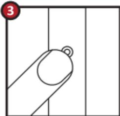
Der Akku ist mit einem Transportschutz gegen versehentliches Auslösen ausgestattet und befindet sich im Auslieferungszustand im ausgeschalteten Modus. Zum Ein- oder Ausschalten des Transportschutzes drücken Sie die Taste dreimal innerhalb von zwei Sekunden.
